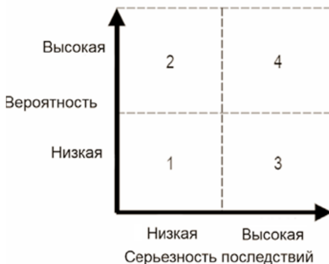
Рисунок 1 - Условия периодичности проведения аналитического контроля для нормального режима работы технологического процесса
